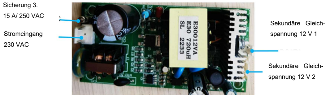
Abbildung 8: Diagramm der Anschlussdefinition des Schaltnetzteils (AP2)
