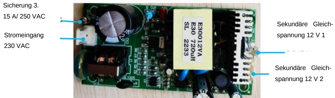
Abbildung 8: Diagramm der Anschlussdefinition des Schaltnetzteils (AP2)
